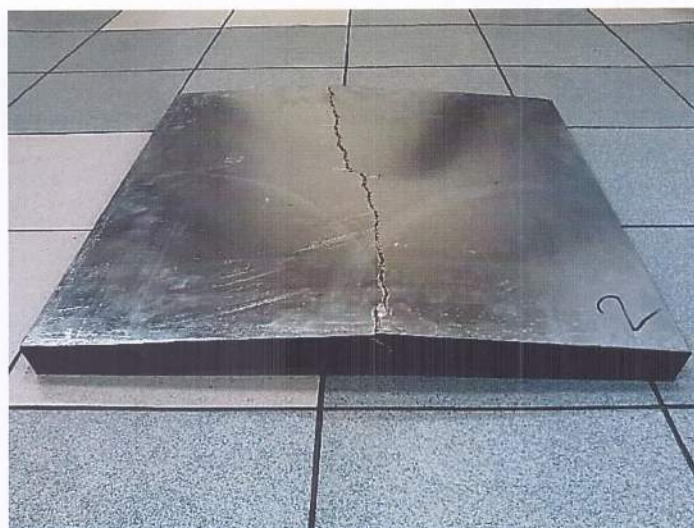
Фото образца после разрушения (вид на нижнюю поверхность)
